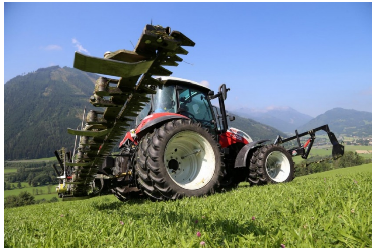
Bild 4: Die Doppelmesser-Mähtechnik hat sich im Schatten der rotierenden Mähtechnik weiterentwickelt und befindet sich heute auf einem modernen Stand. (Foto: BB Umwelttechnik).
